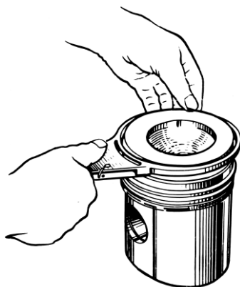
Рис. 79. Щипцы для снятия и надевания поршневых колец:
