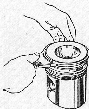
Рис. 85. Снятие и надевание поршневых колец
